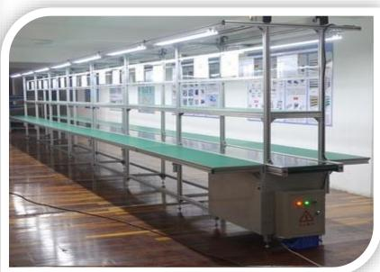
GENERAL SIZE(L\*H\*W)-16000X2200X1200, MATERIAL-ALUMINIUM EXTRUSION
