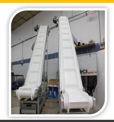
GENERAL SIZE(L\*H\*W)-5500X3200X550, MATERIAL-ALUMINIUM EXTRUSION
