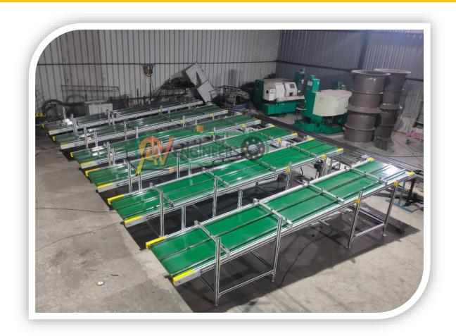
GENERAL SIZE(L\*H\*W)-5000X900X500, MATERIAL-ALUMINIUM EXTRUSION
